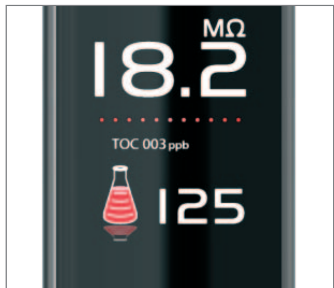
Figure 4 : ELGA PURELAB Chorus 1 avec afficheur du distributeur Halo indiquant la mesure du COT
