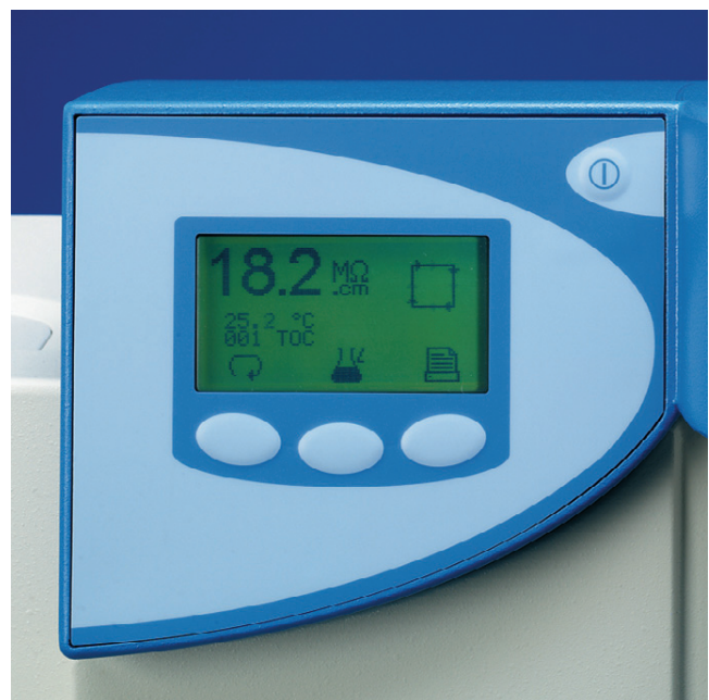
Abbildung 4 - Display von ELGA PURELAB Ultra zeigt die TOC-Messung an.
