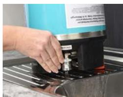
Vider l'eau d'un échangeur d'ions épuisé
