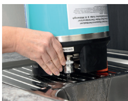
Wasser entleeren aus erschöpftem Ionenaustauscher
