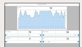
Toutes les fonctions et valeurs essentielles de l'appareil sont surveillées. Démarre ou arrête l'installation à l'aide des capteurs de niveau dans le réservoir de stockage raccordé ou active l'alarme dès que des valeurs de fonctionnement importantes dépassent les valeurs limites programmées.
